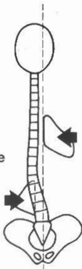
Abb. 15 Wirbelsäulen-Orthesen zur Behandlung einzelner lumbaler oder thoraco-lumbaler Biegungen haben oft den Fehler, daß sie Gegenkräfte im mittleren Thorakalbereich ausüben. Diese Kraft trägt dazu bei, den Cobb'schen Winkel zu reduzieren und die Orthese zu stabilisieren. Diese Kraft trägt jedoch auch zu einem nach links gerichteten Fehlverlauf (Dekomensation) der Wirbelsäule des Patienten bei. Dies steht dem primären Wirkungsziel der Orthese für den Patienten fundamental entgegen.
