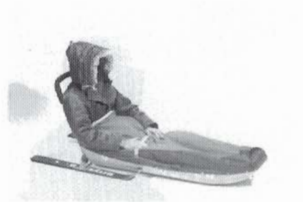
Abb. 3 Modifikation eines Lastschlittens für einen Tetraplegiker.
