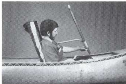
Abb. 2 Modifikation eines Kanu-Sitzes und des Paddels für einen halbseitig Gelähmten.
